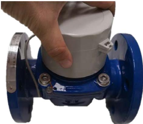
3.6. Introduzca el cable a través del orificio inferior de la tapa protectora de la relojería.
