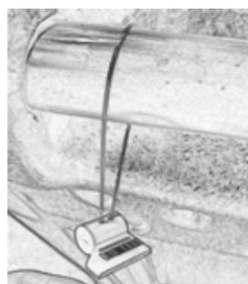
Introducir la punta del alambre en otro orificio atravesando el objeto a precintar
